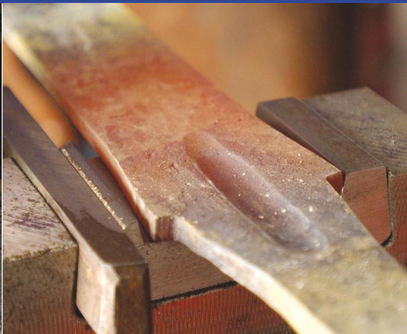
*Geschmiedet wurden die Schwerter in Holzkohle (oben), die Hohlkehle ist mit einem Gesenk eingeschmiedet und nicht wie bei japanischen Klingen spanabhebend aus dem Material entfernt (oben rechts).*
